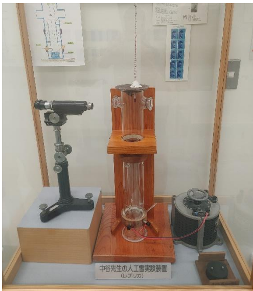
図 1 中谷先生の人工雪実験装置(レプリカ)
